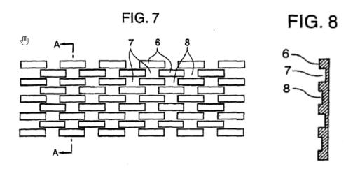
Die hervorstehenden Abschnitte 6 wölben sich auf der Rückseite hervor ("... bulges out on the reverse side by an amount corresponding to 20 rows ..."), indem diese zu einer Reihe zusammengezogen werden ("... being pulled into 1 row by a loop"), vgl. den Absatz [0029].
