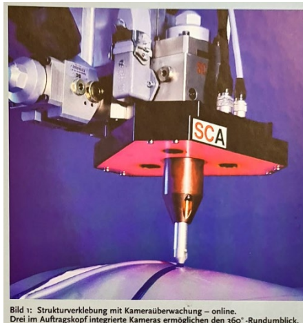
Bild 1: Strukturverklebung mit Kameraüberwachung – online. Drei im Auftragskopf integrierte Kameras ermöglichen den 360°-Rundumblick.
