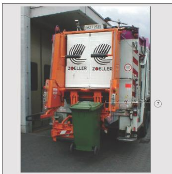
Abb.5.4: Anheben des Behälters
