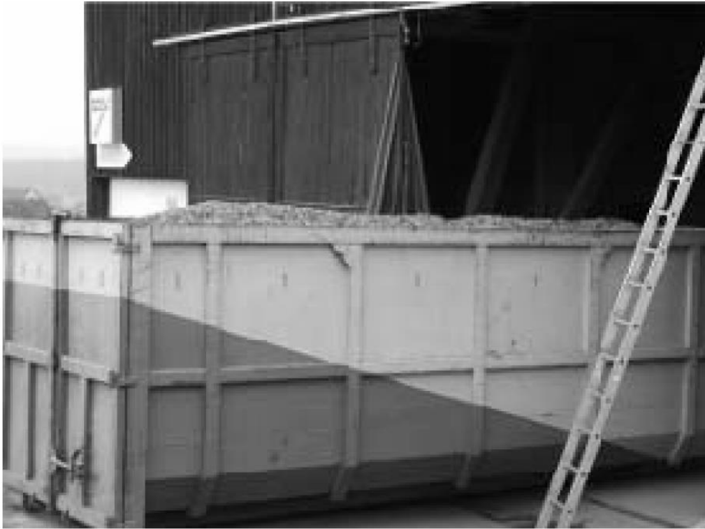
D8, Abbildung 10-4 Container zur Hackschnitzeltrocknung
