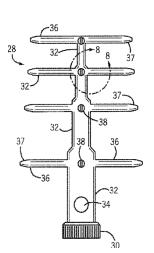
nem ersten Ende und einer Mehrzahl von Löchern an einem zweiten Ende (Fig. 7 - M1.1) und einer Mehrzahl integral mit dem Gehäuse verbundenen hohlen Röhren 36/37, die jeweils an einem der Löcher am zweiten Ende des Gehäuses angebracht sind (Fig. 7 - M1.1, M1.2). Weiterhin entnimmt der Fachmann der D15 unmittelbar und eindeutig eine Mehrzahl von Ballons als Behälter, die jeweils mit einem der hohlen Röhren lösbar verbunden sind (M1.3).
