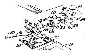
So zeigt die D5 eine in einer Geschenkverpackung angeordnete Ballonfüllvorrichtung, bei der ein Drucklufttank über ein Verbindungselement 42 mit mehreren Ballons verbunden ist (vgl. Figur 3). Das schlauchförmige Verbindungsele-
