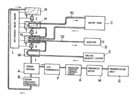
Z 28 bis 33 iVm der Fig 1. Da ein alleiniger Betrieb des Dampfmotors hier nicht möglich ist, dient der Anschluss des Fahrzeugkühlkreislaufs C ausschließlich zur Vorwärmung des Wassers, das anschließend durch die Abgaswärme verdampft wird. Der Abdampf kondensiert spätestens in dem Dampfkondensator bzw -puffer B, der allerdings eindeutig erkennbar nicht mit dem Fahrzeugkühlkreislauf verbunden ist und deshalb auch nicht von diesem gekühlt werden kann, wie streitpatentgemäß vorgesehen ist.
