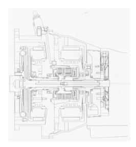
Kupplungen K1 und K2 mindestens teilweise radial und axial innerhalb der elektrischen Maschine EM 2 angeordnet sind.
