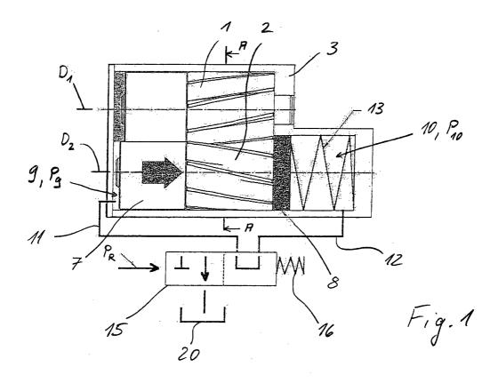
Auf jeder Seite des Kolbens 7/8 ist ein Druckraum 9, 10 angeordnet, wobei im zweiten Druckraum ein Federelement angeordnet ist. Der erste und der zweite Druckraum 9, 10 sind über eine erste und eine zweite Fluidverbindung 11, 12 mit der Hochdruckseite der Pumpe verbunden.
