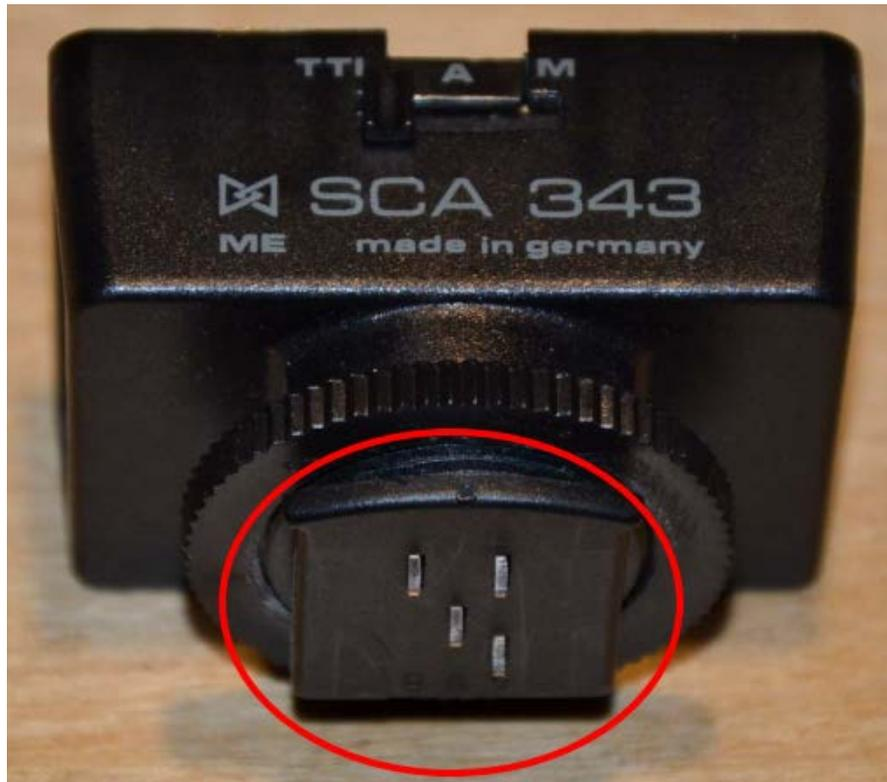
Damit weist der Adapter SCA343 als ein Anwendungsbeispiel eines Adapters für die Schnittstelle Blitz – Kamera also ein Gehäuse auf, das mittels einer Schienen-Trapez-Verbindung im Sinne des Merkmals **M5** formschlüssig verbunden an der
