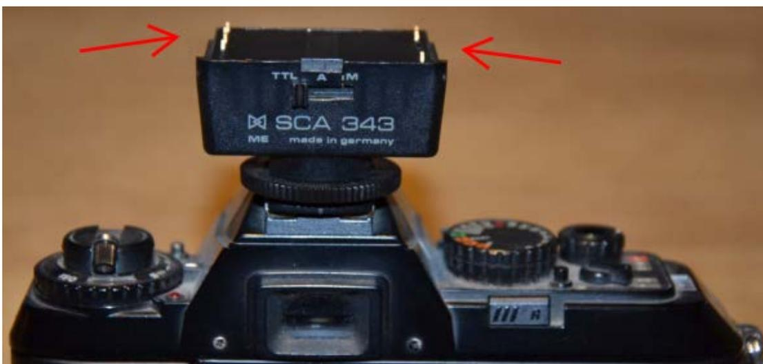
Spiegelreflexkamera befestigt wird (entspricht der Fixierbarkeit des Adapters im Sinne des Merkmals **M4**) und zudem Anschlusselemente im Sinne des Adapter-Spule-Anschlusselements gemäß Merkmal **M2** (siehe Pfeile im letzten Bild) sowie Anschlusselemente im Sinne des Adapter-MRT-Anschlusselements gemäß Merkmal **M3** (siehe Kreis im zweiten Bild) aufweist.
