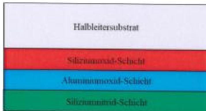
Struktur des Schichtstapels nach dem Streitpatent
